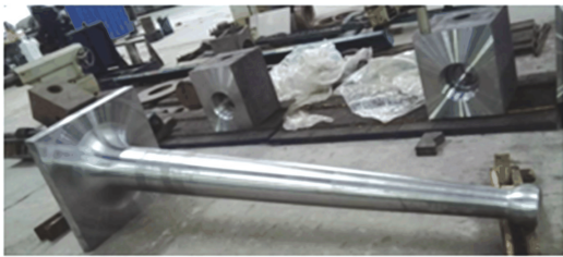
图 20 金属限位减震装置加工制造实物照片
